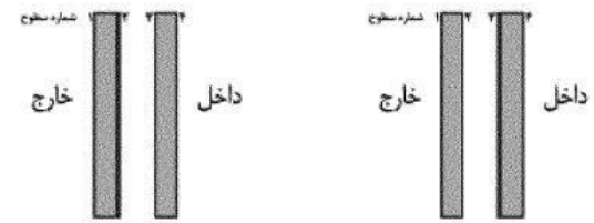
شکل 8 - محل قرارگیری پوشش کم‌گسیل در مناطق سردسیر (سمت راست) و گرم‌سیر (سمت چپ)
