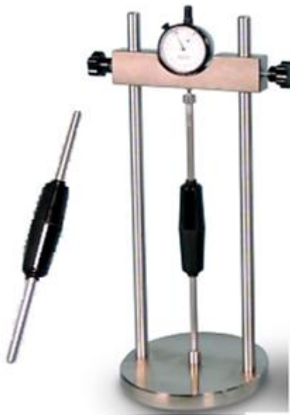
شکل ۳-۲ دستگاه قرائت کرنش سنج (تغییرات طول) و میله مرجع مطلق با استاندارد ASTM C490
